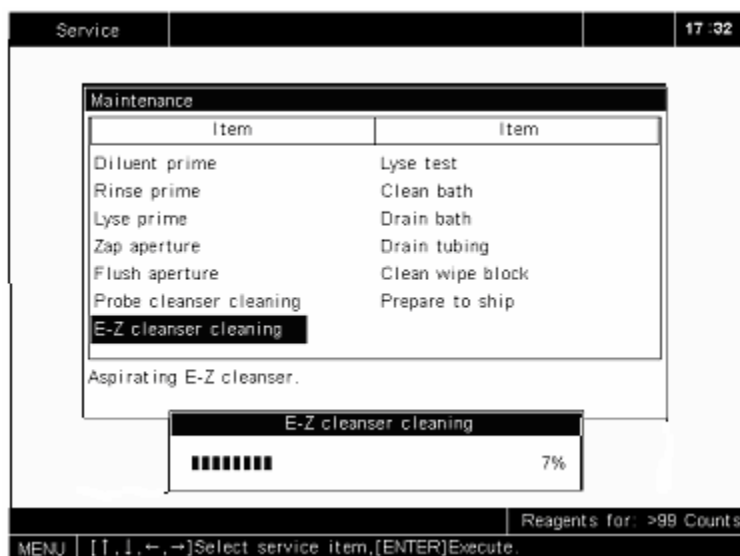
Рисунок 10-12 Промывка кюветы и жидкопроводящих путей
